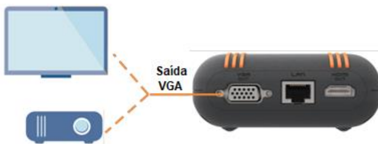
Figura 13: conexão ao visor da sala com VGA
