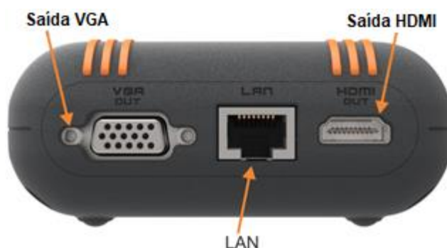
Figura 4: conexões de saída
