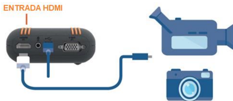
Figura 11: conexão de câmera digital com HDMI
