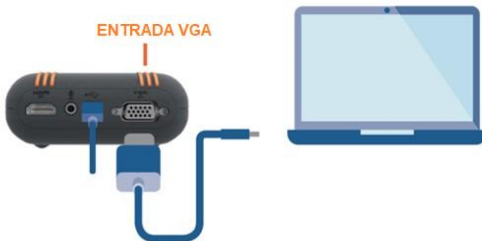
Figura 8: conexão ao laptop com VGA
