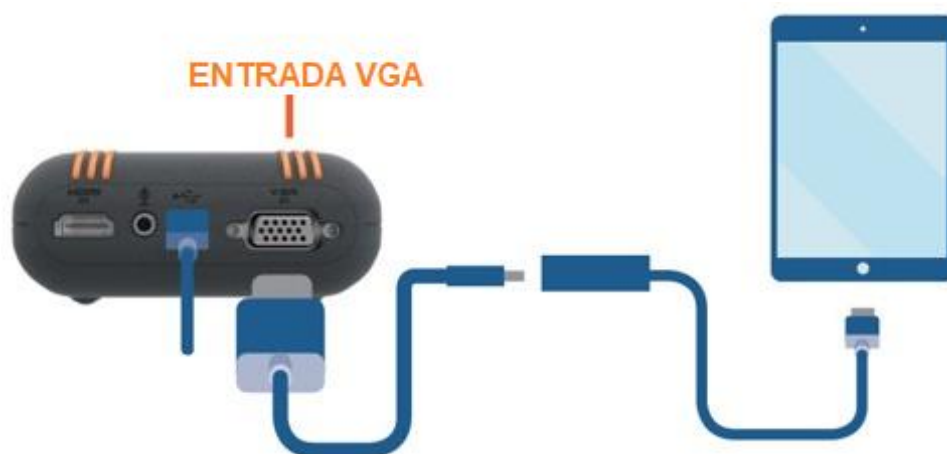
Figura 10: conexão ao smartphone/tablet com VGA
