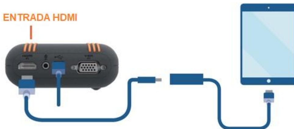
Figura 9: conexão ao smartphone/tablet com HDMI
